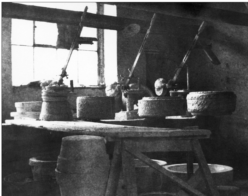
Obr. 84. Mechanické zatáčecí kruhy. Tři kruhy s charakteristickými masivními hlavicemi a charakteristickými kyvnými rameny; na třetím ramenu zřetelná šablona, pod stolicí sádrové formy. Reprodukce fotografie blíže neurčené dílny z doby kolem roku 1960 (soukromý majetek)
