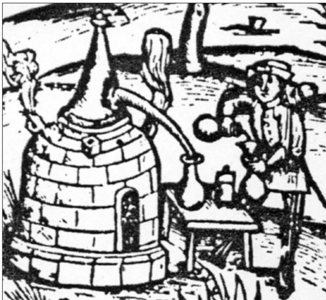
Obr. 1. Terénní destilační pec s charakteristickým rektifikátorem, tj. nástavcem s chladičem a s boční trubicovou výpustí. Výřez z vyobrazení knihy Liber de arte distillandi z roku 1512 (Weinhold 1975, s. 179, obr. 175)
