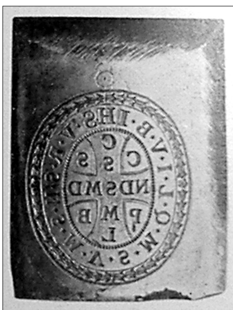
Obr. 31. Ukázka kolků do kapsového stroje pocházejícího z dílny P. a P. Seela v Salcburku. Převzato z Roll 1914, Taf. I, Nr. 3
