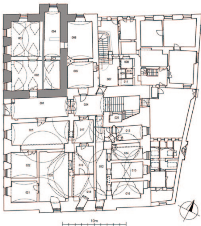
Obr. 33. Český Brod, č. p. 1, přízemí. Tmavě šedě vyznačena gotická zdíva (14. století) podle archeologických výzkumů. Rozsah sklepa naznačen jednoduchou čarou v interiéru. Podklad podle Pešta – Kyncl – Mrvík 2016 , upravil autor.
