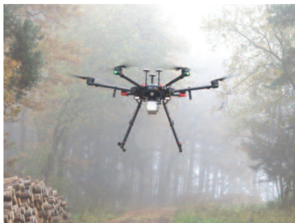
Obr. 5. Veselí nad Lužnicí II. Dron DJI matrice 600 vybavený skenerem Riegl během průzkumu lokality. Foto J. John.
