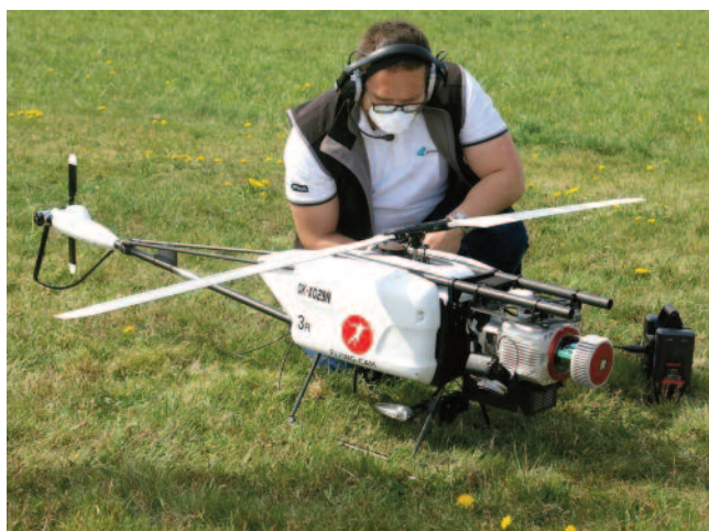
Obr. 3. Ostrolovský Újezd. Dálkově řízený vrtulník Flying Cam SARAH 4.0 vybavený laserovým skenerem těsně před průzkumem pohřebiště Ostrolovský Újezd. Foto J. John.
