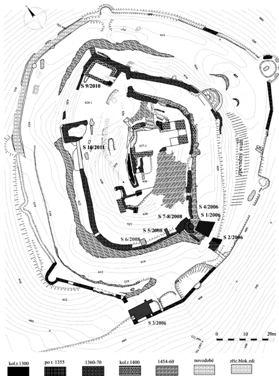
Obr. 1b. Půdorys hradu s rozlišením stavebních fází podle T. Tomička a J. Úlovce, doplněno o plochy zkoumané po roce 2000 (Prostředník 2011, 20)
