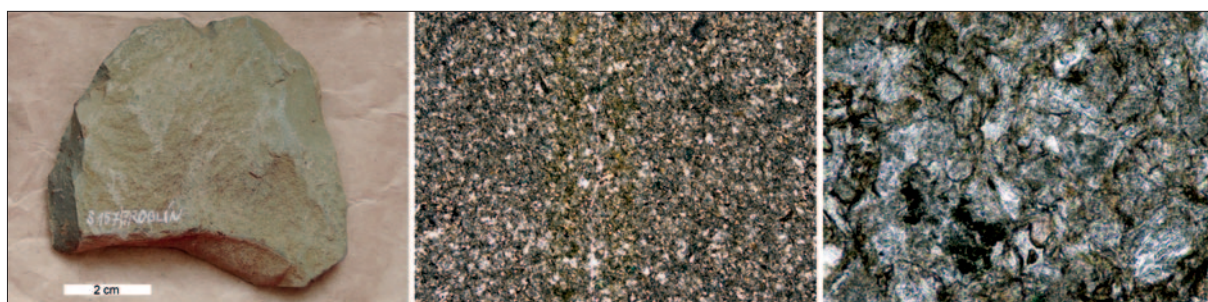
Obr. 9. Roblín (č. a. 157/7). Spilitový tufit I až II; a. makrofotografie; b. mikrofotografie – obrázek v rovnoběžném světle, delší strana obrázku je 2,95 mm; c. mikrofotografie – obrázek v rovnoběžném světle, delší strana obrázku je 0,59 mm. Foto B. Šreinová
