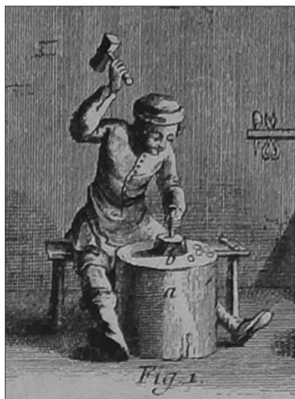
Obr. 3. Obsluha formovacího železa. Podle Diderot 1772, 79, pl. III
