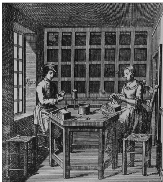
Obr. 19. Ve francouzských manufakturách se vyráběly potahované knoflíky u specifických šestibokých stolů. Podle Diderot 1772, 80, pl. IV
