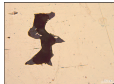
Obr. 47. Vzorek T9, mikroředina v mezidendritické oblasti (zvětšení 100x)
