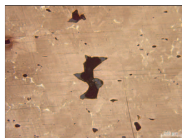
Obr. 51. Vzorek T9, mikrořediny v mezidendritické oblasti (zvětšení 50x)
