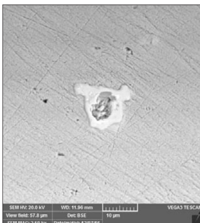
Obr. 74. Vzorek T10, typický útvar segregované fáze bohaté na příměsové prvky (zvětšení 2500×)
