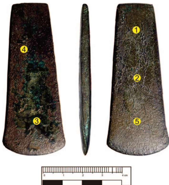
Obr. 4. Kacanovy (okr. Semily). Měděná sekera typu Altheim. Stav po dokončené konzervaci. Žluté číslované body vyznačují místa měření přenosným RFA spektrometrem.
