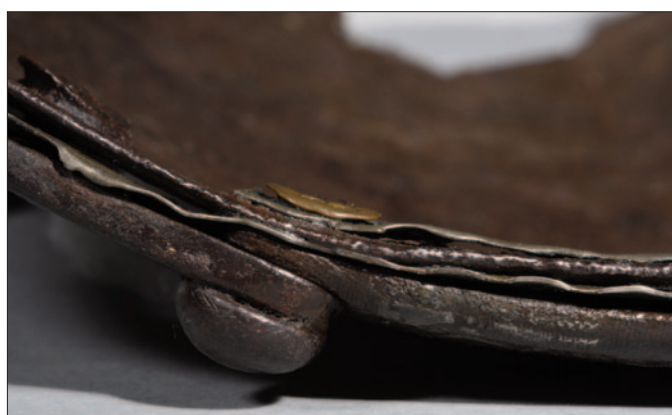
Obr. 35. Pohled na nýt N3, měděnou podložku a stříbrné pásky SP1, SP2. © Správa Pražského hradu, foto Jan Gloc.
