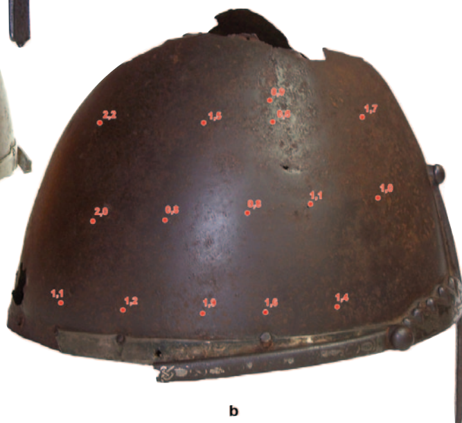
Obr. 12. Tloušťka plechu přilby, pohled zezadu. Foto a zaměření Jiří Klepač.
