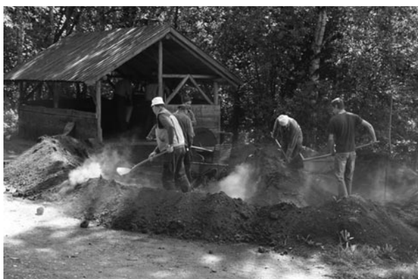
Obr. 7. Rozebírání vypáleného milíře ve skanzenu Neusath–Perschen v Bavorsku v roce 2014. Foto archiv skanzenu.
